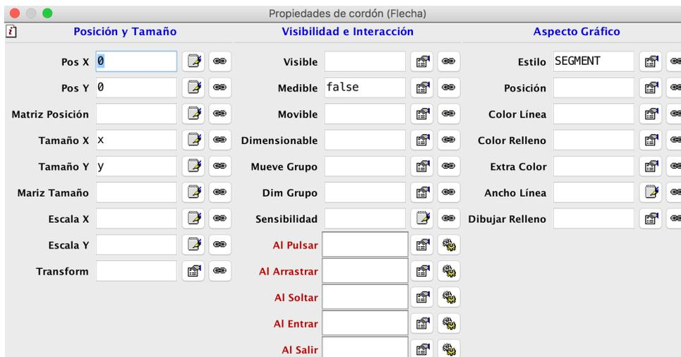
**FIGURA 12.** Cuadro de diálogo “Propiedades”, para el elemento “cordón” de la simulación. Se muestra la posición del hilo, sus dimensiones, su forma de “segmento”.
