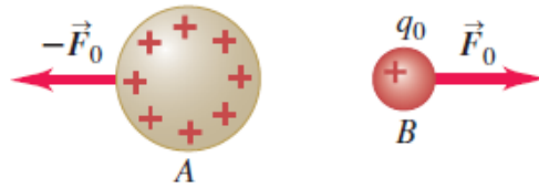
FIGURA 1. Cuerpos con carga positiva. Ambos experimentan una fuerza repulsiva F_0 . Este es un ejemplo en donde la fuerza eléctrica coincide con la dirección del campo eléctrico.
